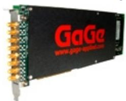
В дополнение к серии Razor CompuScope 16xx с вертикальным разрешением 16 бит компания GAGE выпустила две новые серии плат Razor CompuScope 12x2 и Razor CompuScope 14x2 с разрешением 12 и 14 бит. Каждая серия включает двухканальную и четырехканальную модели с полосой пропускания 125 МГц и частотой дискретизации до 200 Мвыб./с. Объем памяти составляет 128 Мвыб., но может быть расширен до 2 Гвыб.
